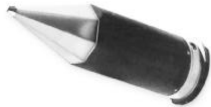
图 10 法国“西北风”肩扛式导弹的八棱锥头罩
