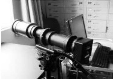
图 2 同时偏振成像探测系统 Fig.2 Detection system of SIP
