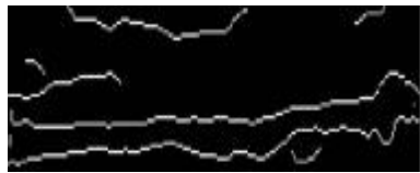
图 4 利用 Canny 算子提取的尾流区边缘图像
