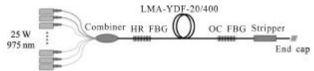
图 1 光纤激光器原理图
