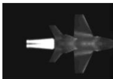
图 12 条件 3 得到的 3\sim 5\ \mu\text{m} 波段的红外仿真图像
