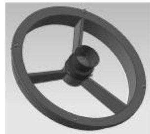
图 6 次镜室及三翼梁结构示意图
