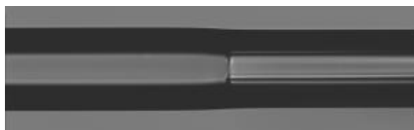
图 5 合束光纤与目标光纤熔接后的显微照片
