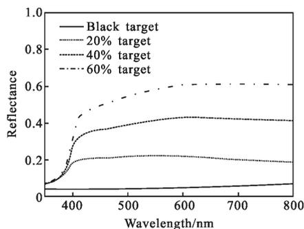
图 2 灰阶靶标的光谱反射率
