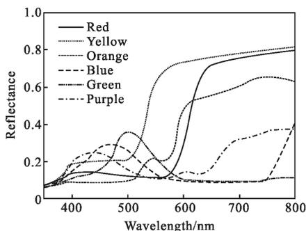
图 1 彩色靶标的光谱反射率
