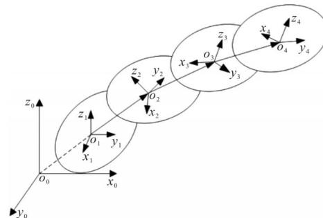
图 2 望远镜拓扑结构
