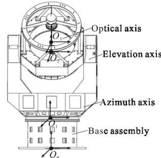
图 1 地平式光电望远镜
