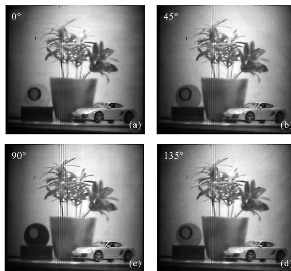
图 5 4 个不同偏振的干涉条纹图像
