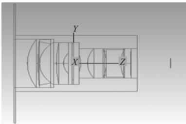
图 5 AZURE-3514MM 镜头的光学系统模型
