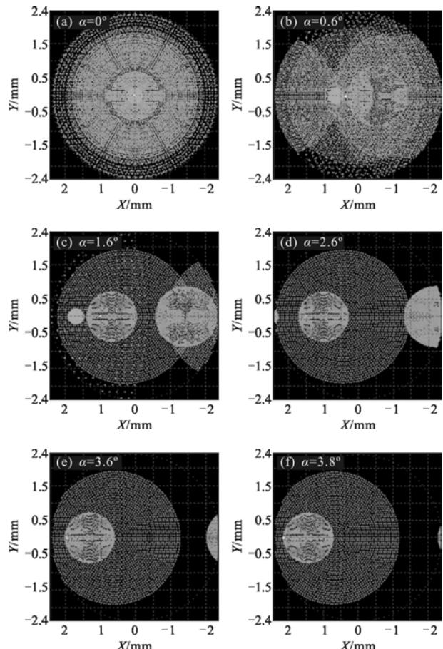
图 6 光电探测器上激光能量分布的仿真
