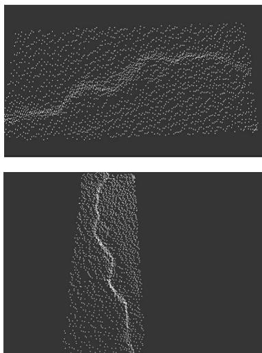
图2 不同角度的路面断板点云数据
