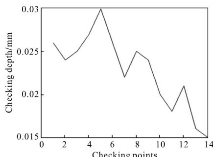
图6 路面断板深度沿水平方向变化趋势
