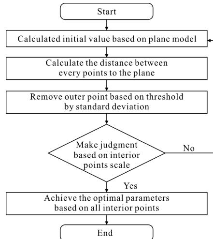
图 4 算法流程图
