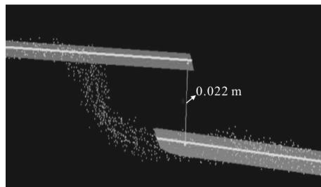
图 5 路面断板深度结果
