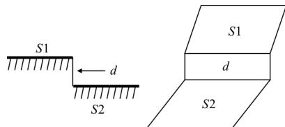
图3 路面断板深度检测原理示意图
