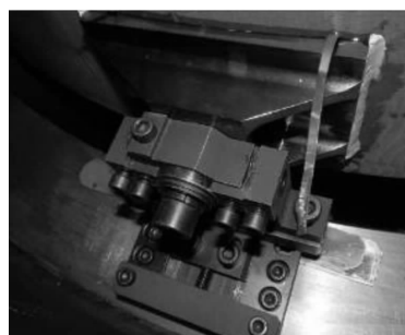
图 6 侧向支撑点胶接定位工装
