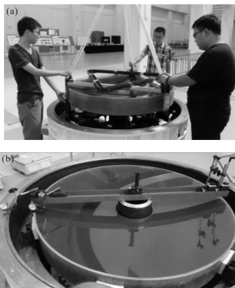
图 5 主镜安装和主镜调整
