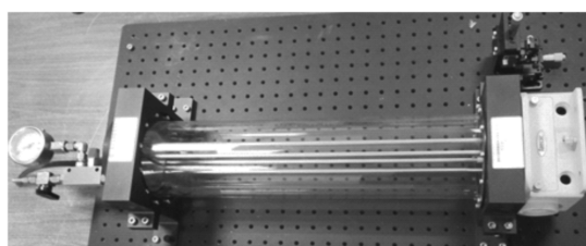
图 12 Cyclone™ 系列 2.1~10.6 m 可变路径长度的多通道水汽气体吸收池
