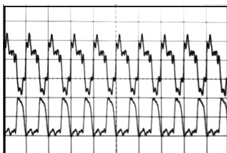
图 2 CCD 视频信号与采样时钟信号干扰图
