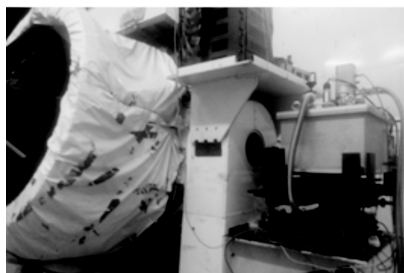
图 11 冷光学终端与大口径望远镜对接
