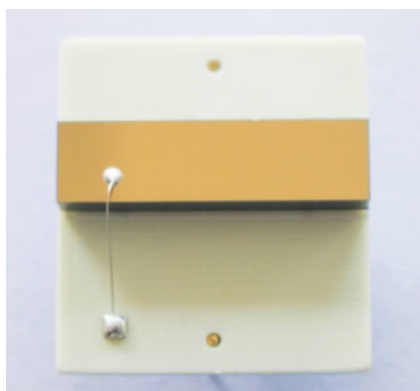
图 2 CdZnTe 光子计数探测器封装结构
