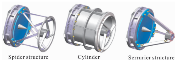
图 6 三种次镜支撑结构
