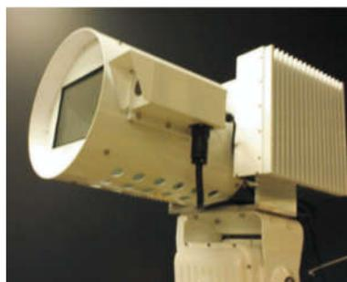
图 16 Rebellion Photonics 气体云团成像仪
