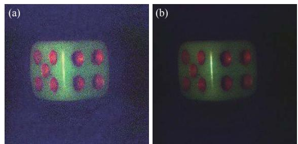
图 8 (a) 反射率校正后的彩色图像; (b) 去除背景噪声和色差补偿后的彩色图像
