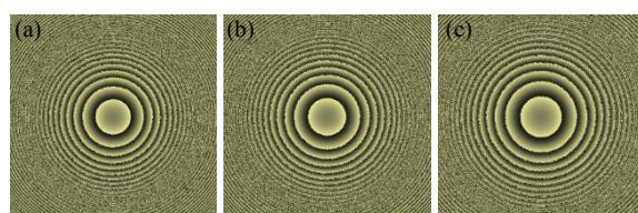
图 4 焦距分别为 245 mm 和 255 mm 的双透镜相位掩模; (a) 掩模波长 492.8 nm; (b) 掩模波长 562.8 nm; (c) 掩模波长 672.8 nm
