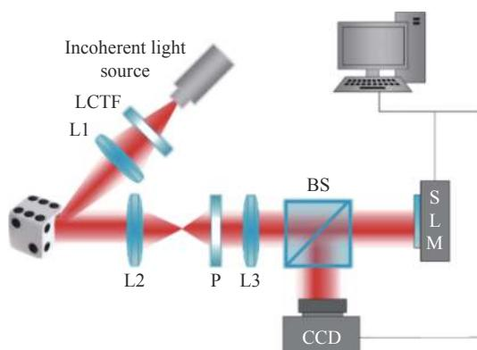
图 2 实验装置。BS, 分束器; P, 偏振片; L1, L2 和 L3, 会聚透镜
