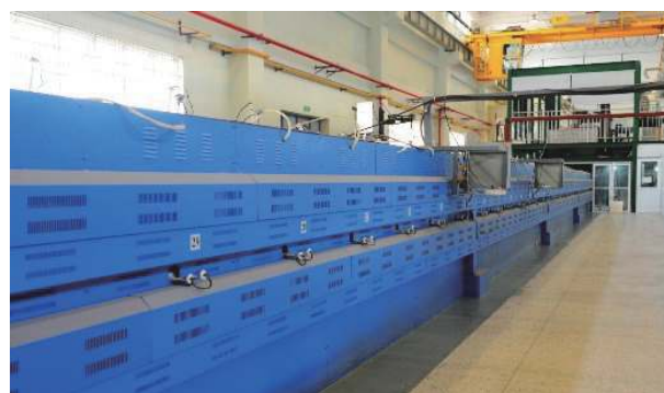
图 3 磷酸盐钕玻璃连续熔炼生产线
