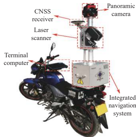
图 4 VSurs-Q 移动测量系统
