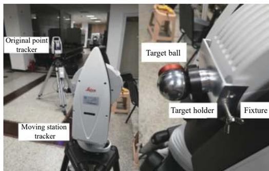
图 5 自标定示意图与夹具连接示意图
