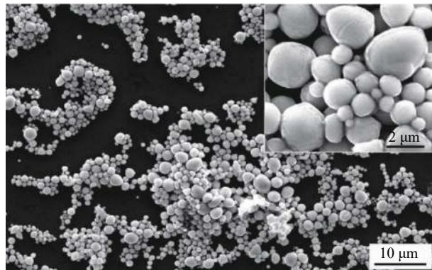
图 4 激光水下烧蚀 Ge 靶后产物颗粒的 SEM 图像
