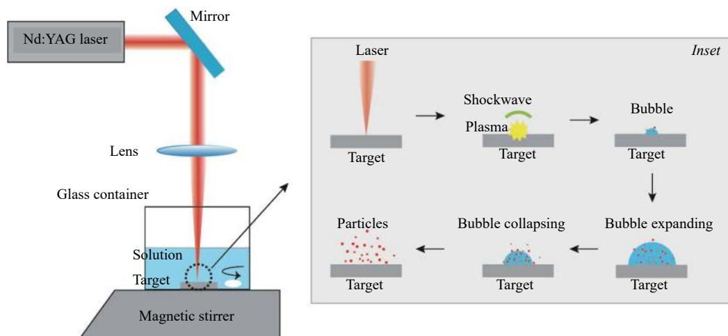
图 1 液相激光烧蚀法制备材料装置图
