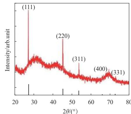
图 2 激光水下烧蚀锗靶后的产物 XRD 谱
