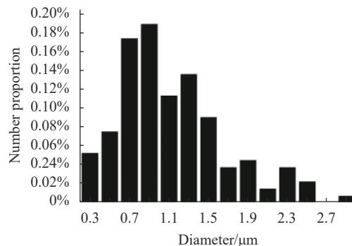
图 5 激光水下烧蚀 Ge 靶后产物颗粒的粒径分布
