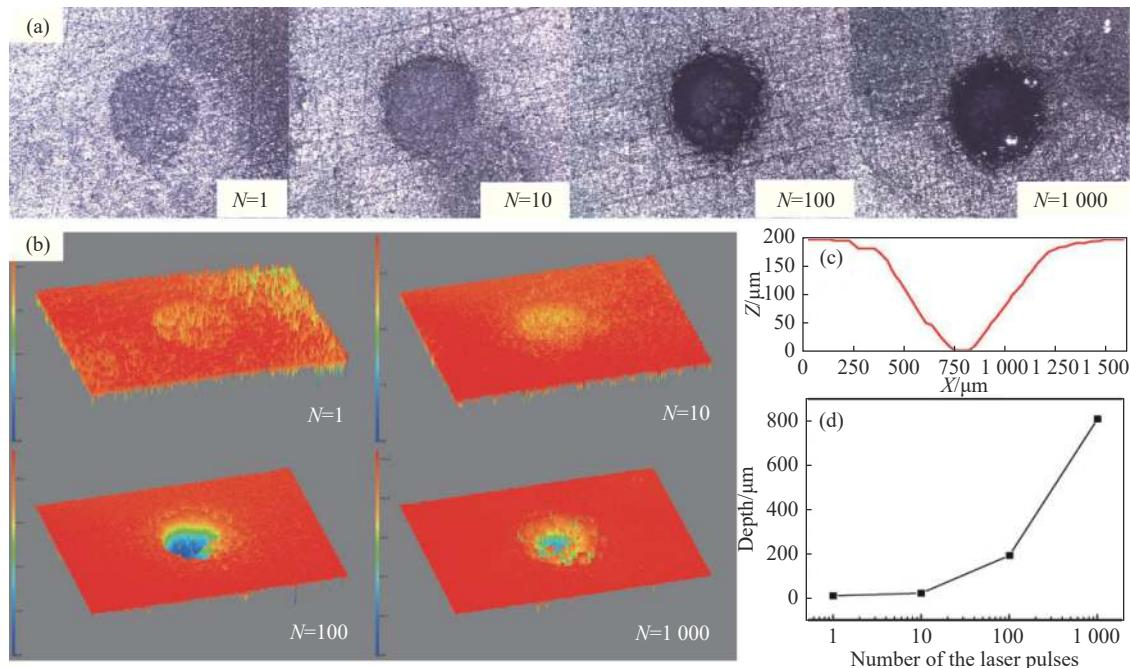
图 6 不同数量的激光脉冲烧蚀后的靶材形貌
