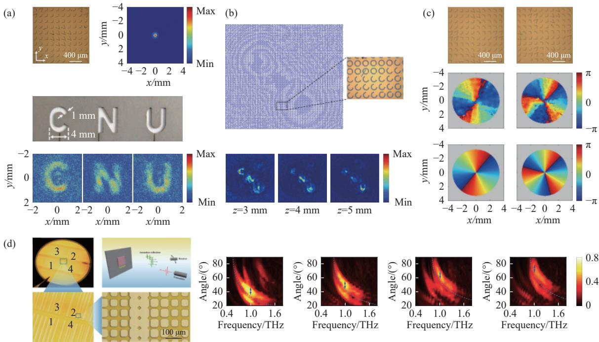
图 2 典型太赫兹波前调制超表面。(a) 太赫兹超表面透镜及其聚焦和成像性能测试结果;(b) 太赫兹全息超表面及其在不同位置处重建的字母图;(c) 不同拓扑数的太赫兹涡旋超表面及其产生的涡旋光场的相位分布;(d) 太赫兹编码超表面及其产生的波束偏转测试结果
