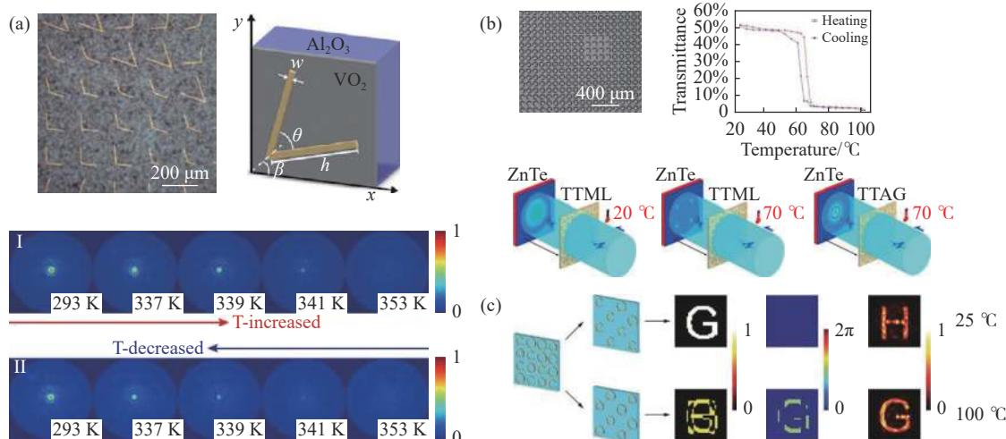
图 4 温控太赫兹波前调制超表面器件。(a)V 形金结构超表面与 VO<sub>2</sub> 薄膜形成的太赫兹温控超表面透镜;(b) 直接刻蚀 VO<sub>2</sub> 材料形成的 C 形狭缝结构超表面透镜及环形艾里光束发生器;(c)VO<sub>2</sub> 材料填充的 C 形金结构形成的太赫兹全息超表面
