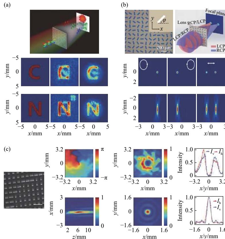
图3 功能复用的太赫兹波前调控超表面。(a) 波分复用的太赫兹超表面功能示意图及其在 0.5 THz 和 0.63 THz 处重现的图像;(b) 基于 PB 相位的偏振复用超表面透镜及其在不同偏振的太赫兹波入射时的聚焦结果;(c) 用于产生涡旋/Bessel 光束的基于 Mie 共振的全介质偏振复用超表面及其在  $x$  偏振和  $y$  偏振的太赫兹波入射时的波前调控实验结果
