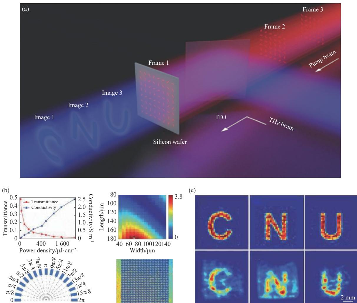
图 5 (a) 太赫兹波前调制全光等离子体超表面示意图;(b) 基于 PB 相位的光致天线设计;(c) 用 CCD 捕获到的投影到硅片上的光致全息图
