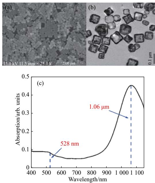
图 1 (a) 2 μm 比例尺下银纳米立方体的 TEM 成像;(b) 0.1 μm 比例尺下金纳米笼的 TEM 成像;(c) 金纳米笼的吸收光谱
