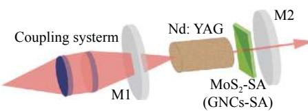
图 3 金纳米笼 (MoS<sub>2</sub>) 为饱和吸收体的 Nd:YAG 被动调 Q 激光器实验装置图
