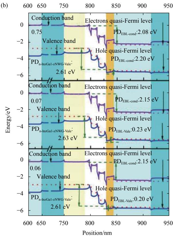
图 6 在注入 0.5 A(即电流为密度 6 kA/cm<sup>2</sup>)时,能带随 n-In<sub>x</sub>Ga<sub>1-x</sub>N 波导层铟组分的变化曲线
