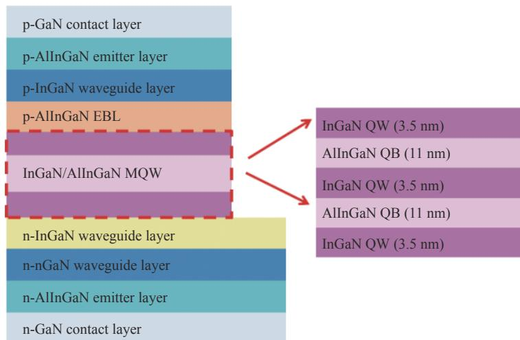
图 1 InGaN 基绿光 LD 的外延结构
