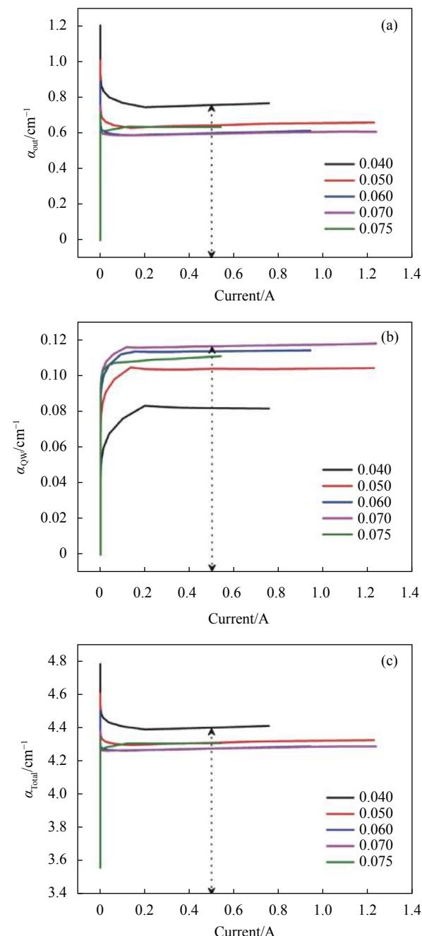
图 4 不同 n-In<sub>x</sub>Ga<sub>1-x</sub>N 波导层铟组分下 LD 的多个量子阱外 ( $\alpha_{out}$ )、内 ( $\alpha_{QW}$ ) (b) 和总光损耗 ( $\alpha_{Total}$ ) (c) 随注入电流的变化曲线 (箭头所指 0.5 A 即 6 kA/cm<sup>2</sup>)
