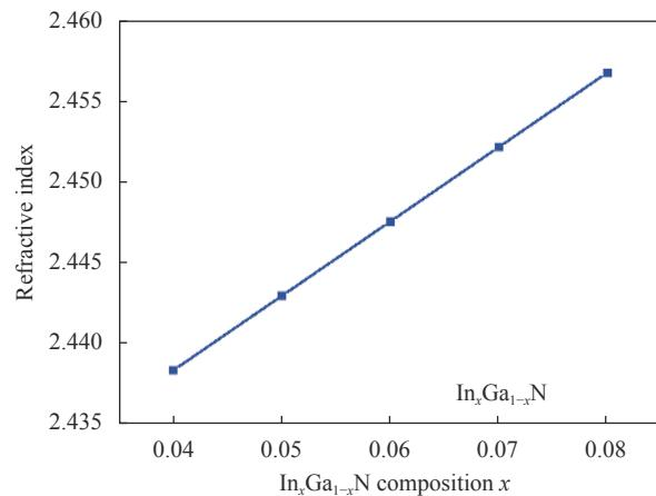
图 2 波长在 525 nm 时 x 为 0.04~0.08 的 In<sub>x</sub>Ga<sub>1-x</sub>N 折射率曲线图Fig.2 Refractive index of In<sub>x</sub>Ga<sub>1-x</sub>N with x composition 0.04-0.08 at the wavelength of 525 nm
