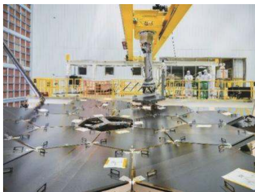
图 6 JWST 采用机器人进行主镜装调
