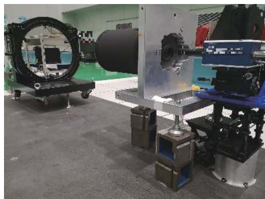
图 7 波前误差测试装置
