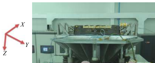
图 9 调焦组件振动试验
