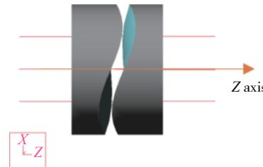
图1 自由曲面透镜组模型
