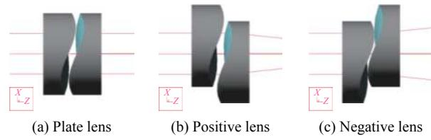
图 2 相对偏移量 $\delta$ 对透镜的影响
