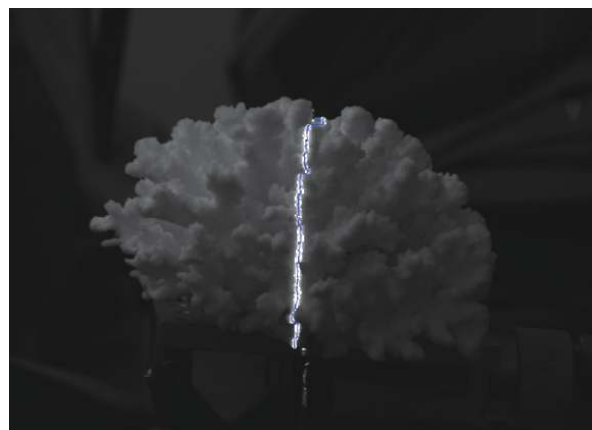
图 4 用改进算法获得激光条纹中心
