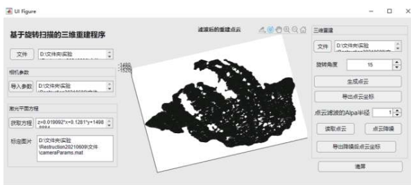
图 10 旋转扫描得到的海螺点云图
