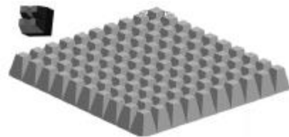
图 3 辐射体的辐射腔单元
