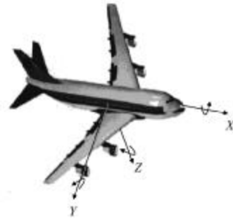
图 1 机体固连坐标系 O_{1x_p y_p z_p} 示意图
