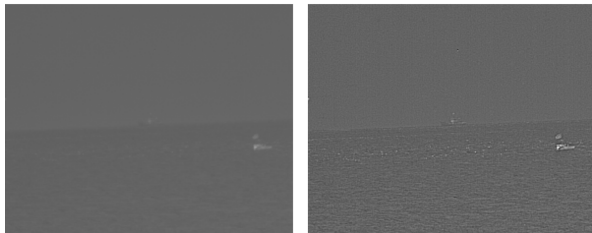
(a) 低 SNR 海天红外图像 (b) Laplacian 模板运算结果 (a) Low SNR infrared image (b) Laplacian template operation results
