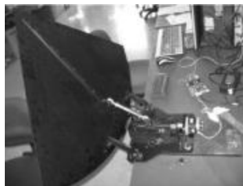
图 7 镜盖开关时间调试
