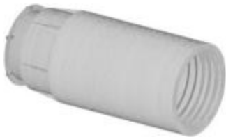
图 2 碳纤维外遮光罩有限元模型 Fig.2 FEM of CFRC outer baffle
