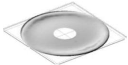
图 6 面形拟合结果 RMS=2.87\text{ nm} ( RMS=0.005\lambda, \lambda=632.8\text{ nm} )
