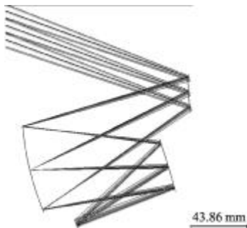
图 1 离轴三反系统结构示意图
