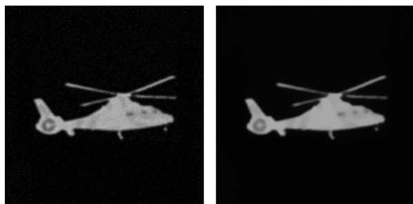
(a) 原始红外图像 (b) TV 方法消噪声结果 (a) Original infrared image (b) Denoised by TV method
