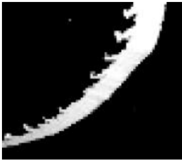
图 4 超精密切削实验得到钛合金锯齿状切屑
