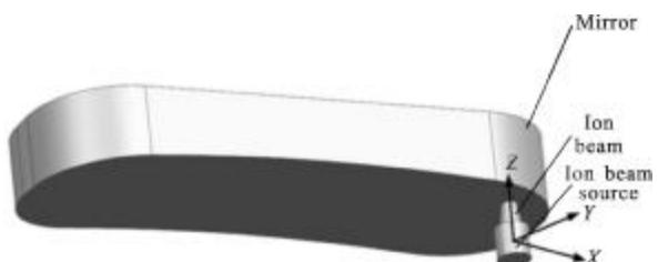
图 1 离子束加工原理示意图
