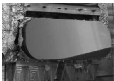
图 3 某主镜组件离子束加工图
