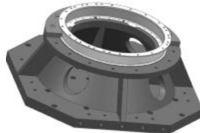
图4 振动夹具与卫星适配器连接方式
