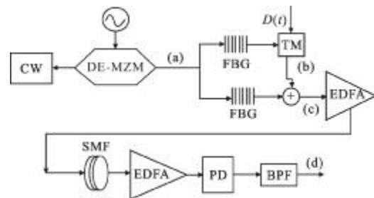
图 1 基于调制边带技术产生毫米波的原理框图
