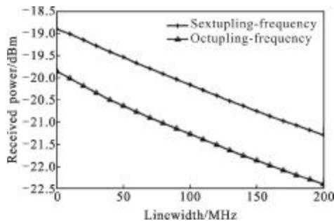
图7 接收毫米波信号与激光器线宽的关系
