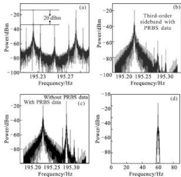
图 2 系统框图 1 中实现六倍频技术时各点的频谱图
