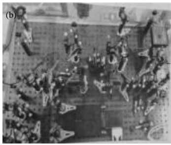
图 2 太赫兹强度调制系统(a)光路示意图(b)实验装置实物图
