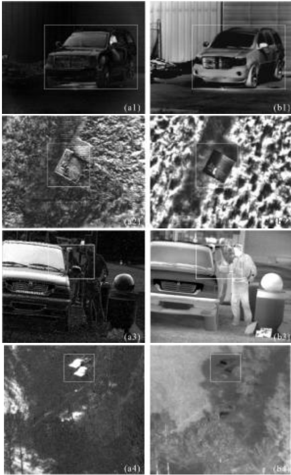
(a) 偏振图像 (b) 光强图像 (a) Polarization images (b) Intensity images
