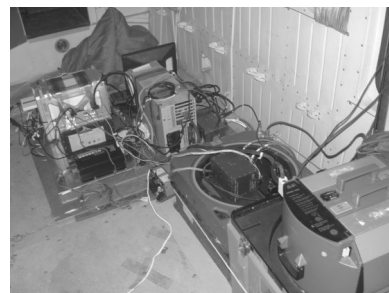
图 7 高光谱成像仪与 PAV30 平台集成
