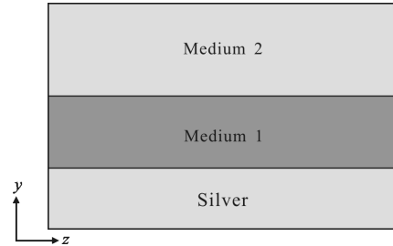
图 1 y-z 平面上的介质加载型表面等离子体波导结构
