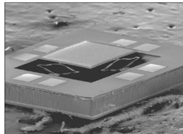
图 2 MEMS 微镜 SEM 图
