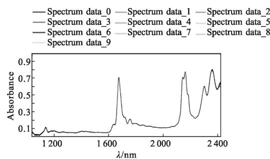
(a) 10 组聚苯乙烯吸光度谱图
