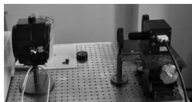
图 4 像面相交干涉光谱成像实验
